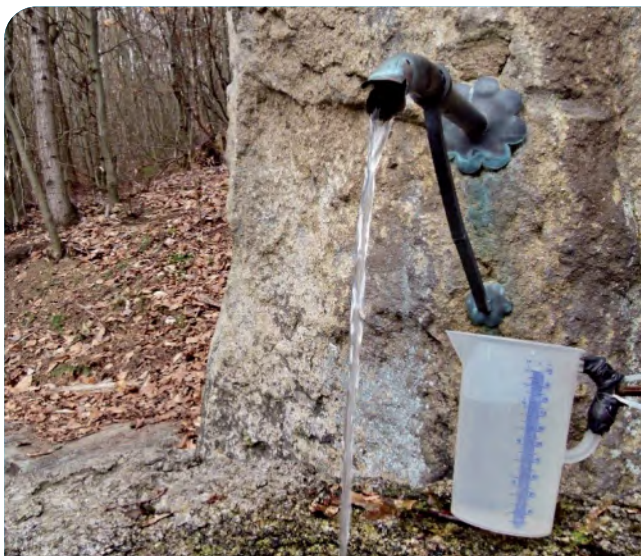
Abb. 4: Geologenbrunnen, Schüttung: für ein 1-Liter-Gefäß brauchte es am 20.04.2021 ca. 6 Sekunden. Das entspricht 8,6 m³ pro Tag, wovon (statistisch betrachtet) ca. 70 Menschen versorgt werden könnten. (Foto: L. Kroll, 2021)
